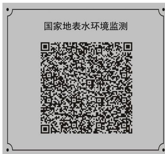
图 7 断面桩背面二维码标识牌示例图
